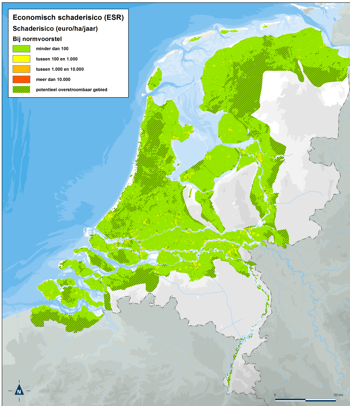
Figuur 5.12 Ruimtelijke verdeling van het economisch risico bij normen volgens normvoorstel.
