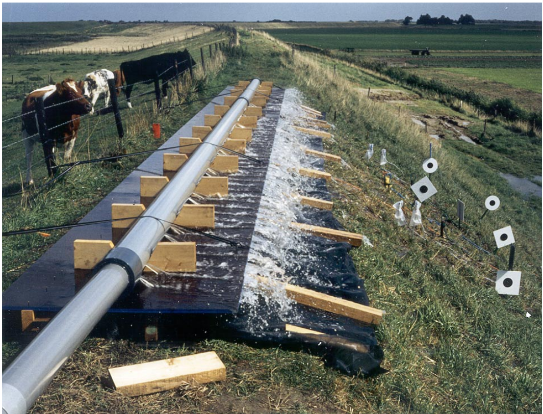
Praktijkonderzoek naar het stabiliteitsverlies door overslaand water
